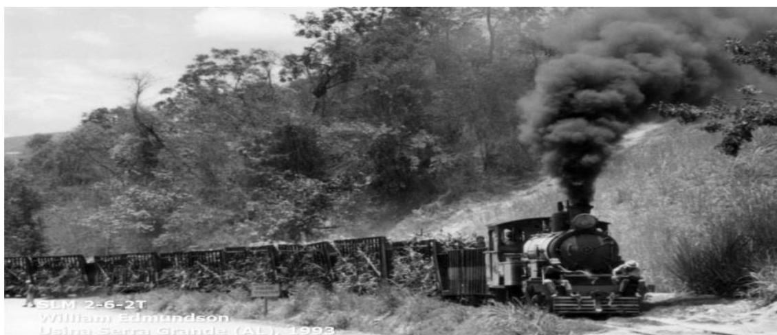
Figura 4: Locomotiva 2-6-2T Swiss Locomotive and Machine Works (1922), ex-GWBR, levando cana até a usina de Serra Grande em Alagoas.<sup>61</sup>
